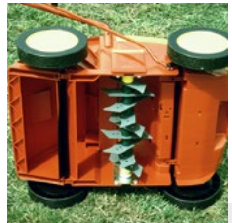
Bild 39: Die Vertikutiermesser sollten nur bis zur Bodenoberfläche reichen.
