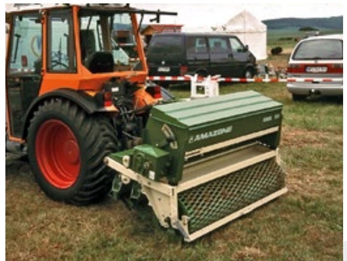
Bild 13: Anbau-Rasensäkombination Amazone GBK 15 mit 1,50 m Arbeitsbreite für den großflächigen Einsatz.
