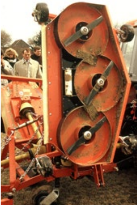
Bild 33: Ein Sichelmäher, hier ein Mulchmäher ohne Auswurf, ist robuster als ein Spindelmäher.
