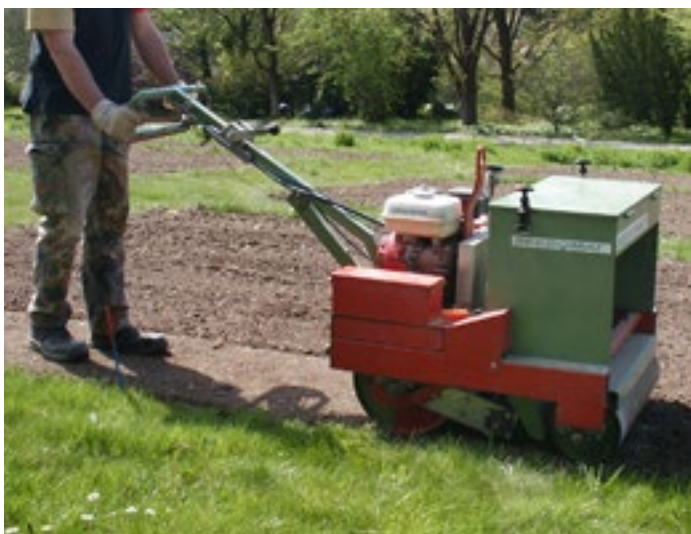
Bild 12: Eine Rasenbaumaschine ermöglicht vier Arbeitsgänge in einem: Vorwalzen - Ansaat - Einigeln - Nachwalzen.
