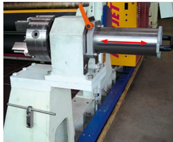
Einspannvorrichtung mit seitenverschiebbarem Backenfutter
