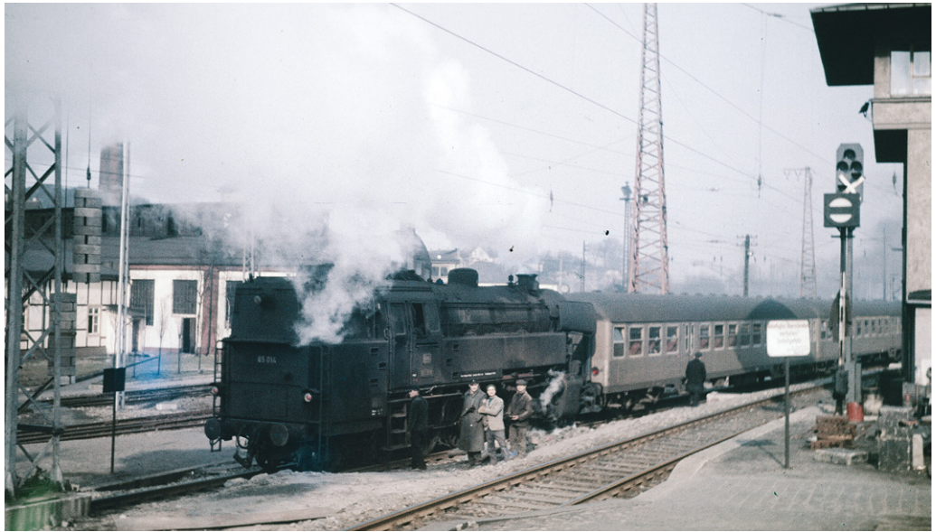
Typisch: Das Foto von Helmut Dahlhaus von April 1964 zeigt eine 65er im Wendezugdienst – an die „Silberlinge“ mit dem Kessel voran angekuppelt.
