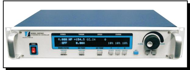
von Motoren. Der DSP6001 Controller, entwickelt für den Einsatz mit Hysteres-, Wirbelstrom- und Magnetpulverbremsen und Drehmomentmesswellen von Magtrol oder zusätzliche Hilfssysteme, lässt sich über die IEEE-488- oder RS 232-Schnittstelle vollständig über einen PC bedienen und steuern. Der DSP6001 ist mit einer Transferrate von 120 Messpunkten pro Sekunde bestens geeignet sowohl für den anspruchsvollen Einsatz im Prüflabor wie auch in Produktionsanlagen.
