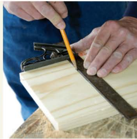
Kürzen eines Brettes mit dem Schreinerwinkel.
