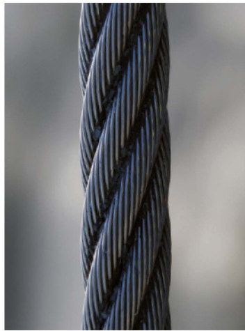
Aus Sicherheitsgründen wird ein Drahtseil aus vielen Drähten zusammengedreht.
