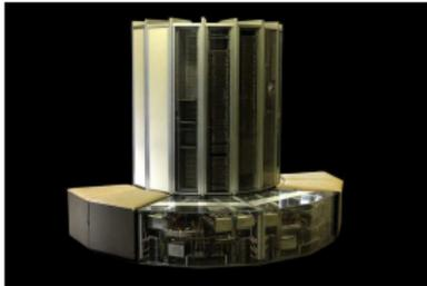
Bei Vektor-Prozessoren steht zwar nur ein Prozessor zur Verfügung, aber dieser ist dank dem Pipelining in der Lage, pro Taktzyklus eine Operation auf einem Vektor umzusetzen. Diese Technik wurde zuerst von der Cray-1 im Jahr 1974 umgesetzt und auch bei späteren Cray-Modellen verfolgt.
