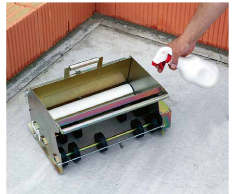
5. Die Mörtelrolle vor der ersten Befüllung dünn mit Trennmittel einsprühen. Das verhindert das Anhaften von Mörtel und erleichtert die spätere Reinigung.
