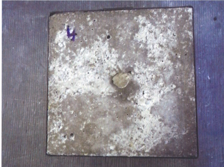
Bild 6: Probe 4 nach 28 Frost-Tau-Wechsel, abgewitterte Oberfläche. Minimale Ablösungen am Abstandshalter erkennbar.
