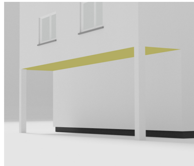
Abb. 4: Aufständering mit horizontaler Dämmung der Untersicht
