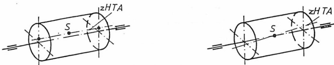
a: Rotorlagerzustand mit Statischer Unwucht
