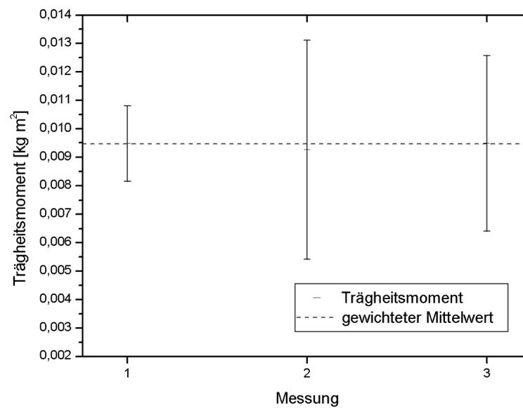
Abbildung 8 - Trägheitsmoment aus der Präzessionsgeschwindigkeit
