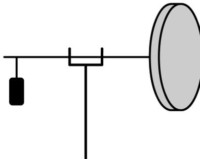
Abbildung 5 - Schema des Versuchskreisels mit Zusatzgewicht
