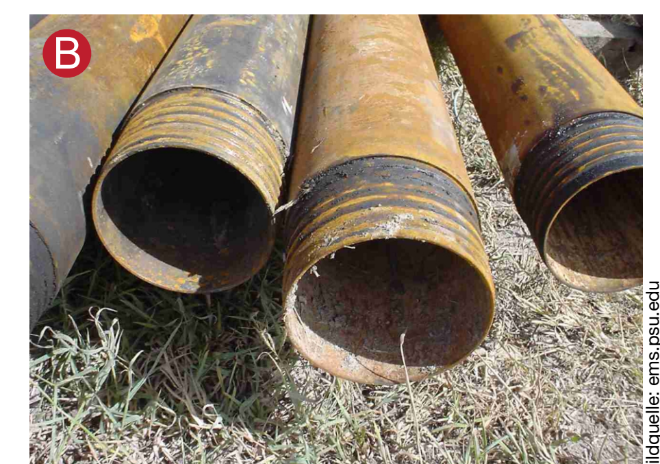
Verrohrung mit Gewinde
