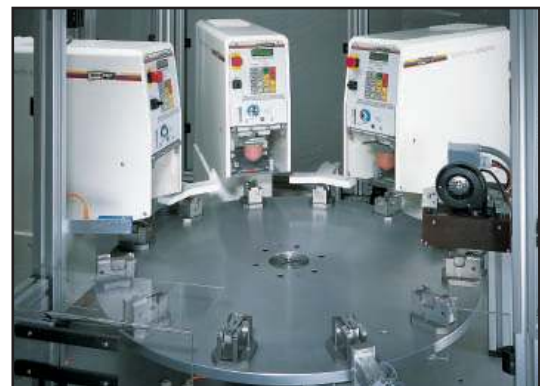
Modul mit 3 Hermetic 6-11 und drehbaren Werkstückaufnahmen
