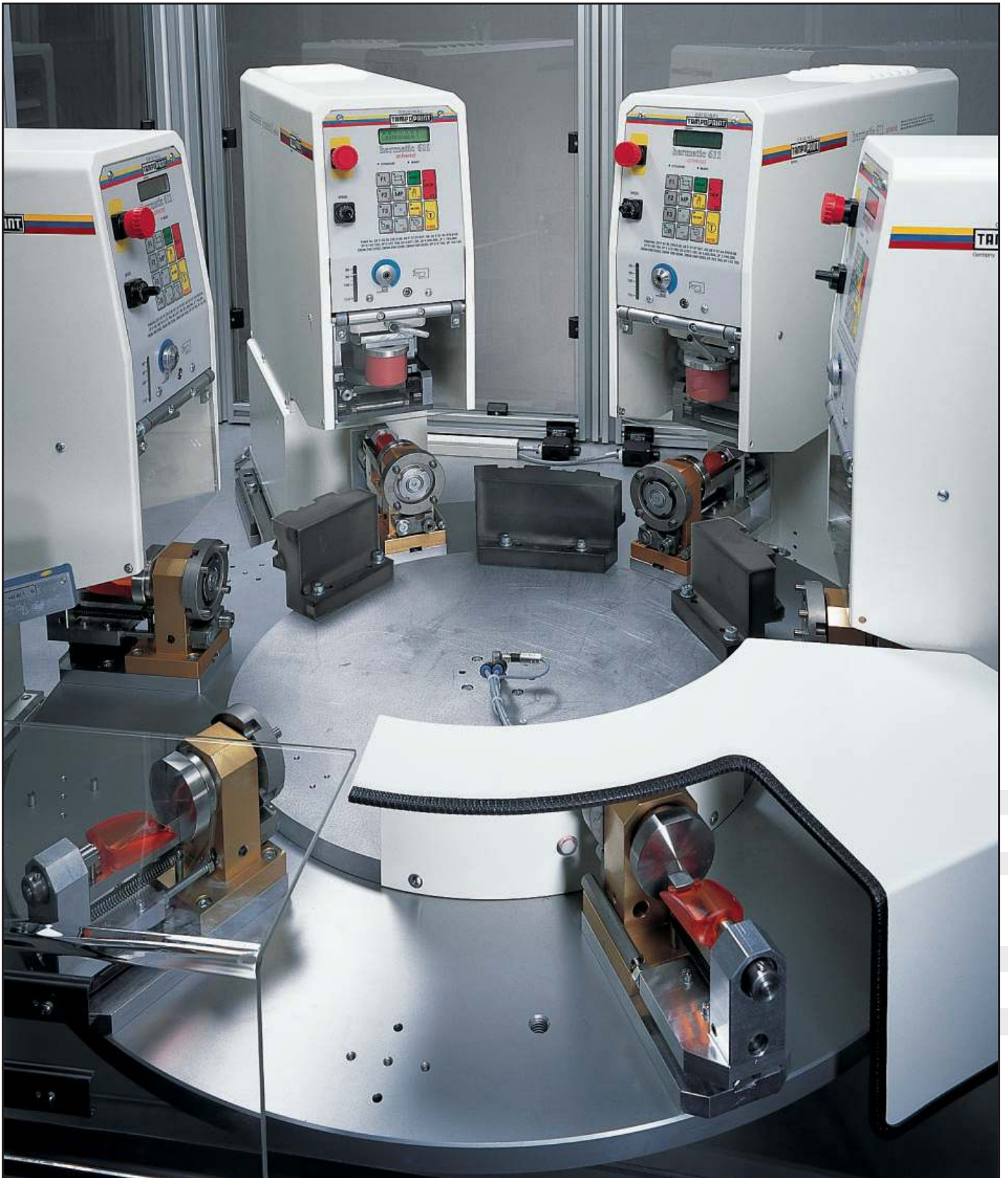
Modul 2000 mit 4 Hermetic 6-11 und drehbaren Werkstückaufnahmen
