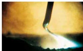
Die Hochleistungs-Lichtbogenarten (HLLB) werden für sehr hohe Abschmelzleistungen und Schweißgeschwindigkeiten unter speziellen Argon-Mischgasen mit Helium-Anteilen verwendet. Je nach Schutzgaszusammensetzung stellen sich unterschiedliche Lichtbogenarten und Werkstoffübergänge ein: Man kann einen Hochleistungs-Kurzlichtbogen (HL-KLB), einen Hochleistungs-Sprühlichtbogen (HL-SLB) und einen rotierenden Lichtbogen (RLB) voneinander unterscheiden.
