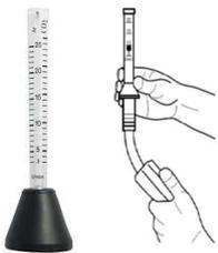
Die Gasmenge kann mit Hilfe eines Gasmengenmessrohres bestimmt werden. Das strömende Schutzgas hebt im kegelförmigen Messrohr einen Schwebekörper entsprechend der Durchflussmenge an. Die Gasmenge ist an der Oberkante der Kugel abzulesen.
