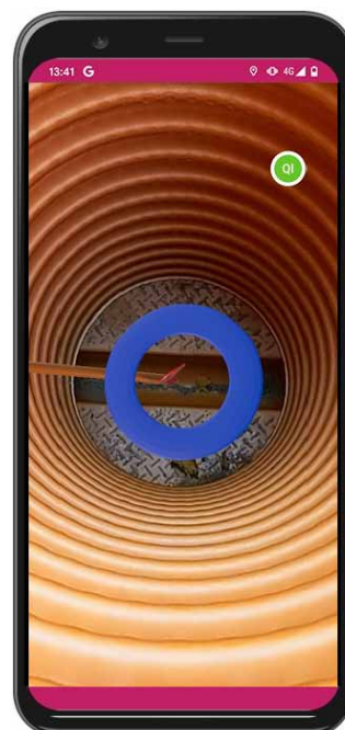
Einmessung eines Revisionsschachts mit der NAVA-App
