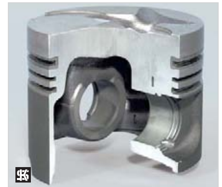
■ Piston à plaquettes rétentrices avec porte-segment
