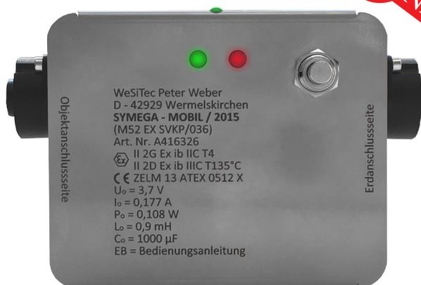
Das SYMEGA MOBIL Erdungssystem mit Prüffähigkeit arbeitet mit einer 3V DC Batterie.
