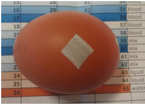
Abbildung 6: Dieses Bild zeigt ein mit Hilfe von Laserstrahlung entfärbtes Ei. Das 10 \times 10 \text{ mm}^2 große behandelte Gebiet kann deutlich erkannt werden. Weiterhin ist der mäanderförmige Bearbeitungsweg sehr deutlich zu erkennen.
