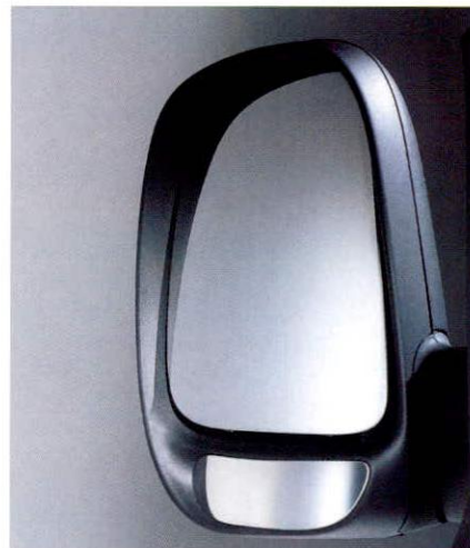
Die großen Außenspiegel sind gegen Verschmutzung weitgehend geschützt und haben ein zusätzliches Weitwinkelglas gegen den „toten Winkel“. Auf Wunsch elektrisch einstellbar und beheizbar.
