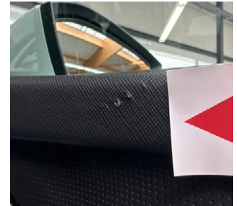
Kratzer in Seitenabdeckung
