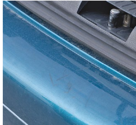
Leichter Lackabrieb &lt; 100 mm
