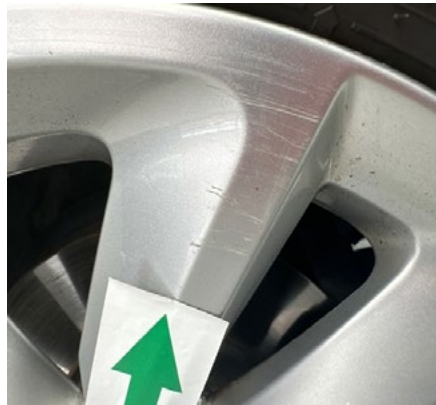
Leichte Kratzer ohne Materialabtragung
