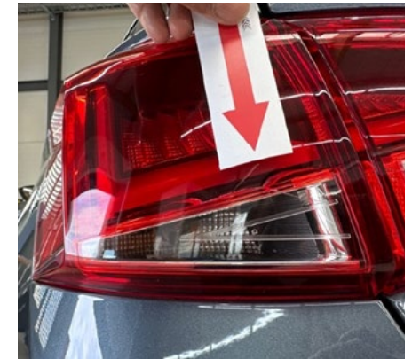
Riss/tiefe Kratzer in Scheinwerfer/Rückleuchte
