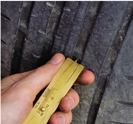
Profiltiefe \geq 4 mm
