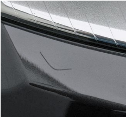
Kratzer in der Lackoberfläche &lt; 100 mm
