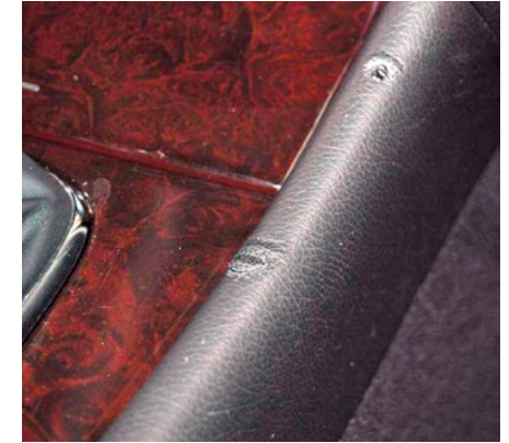
Verformung in der Kunststoffverkleidung
