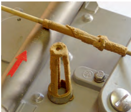
Bild 19: Ablagerungen auf SNCR-Anlagenteilen durch Kalkausfällungen
