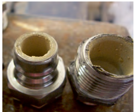
Bild 19: Ablagerungen auf SNCR-Anlagenteilen durch Kalkausfällungen
