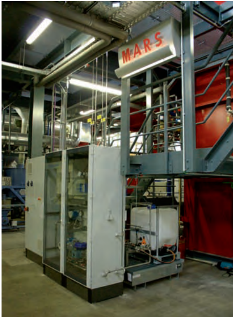
Bild 13: Misch- und Messmodul mit 500 l-Lagerbehälter
