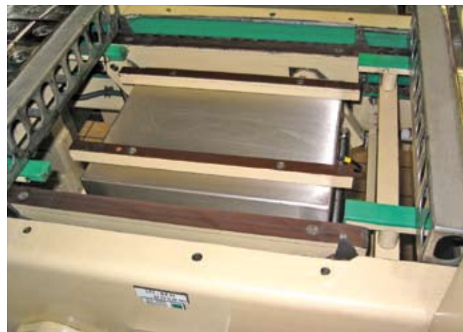
5kg-Schokoladentafel: Nettoinhaltskontrolle mit Plattform von METTLER TOLEDO in der Fördervorrichtung (siehe Bild unten)
