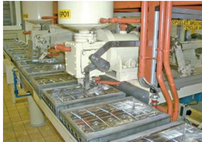
5kg-Schokoladentafel: Nettoinhaltskontrolle mit Plattform von METTLER TOLEDO in der Fördervorrichtung (siehe Bild unten)
