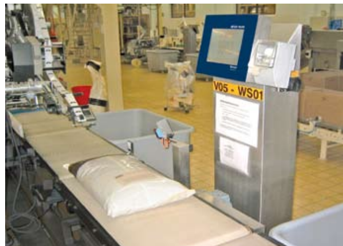
25kg-Tüten Schokoladen-Pellets: 100% Nettogewichtkontrolle per dynamische Kontrollwaage von METTLER TOLEDO Garvens
