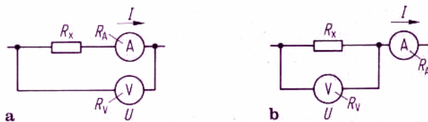
Bild 4. Widerstandsmessung durch gleichzeitige Strom- und Spannungsmessung. A Amperemeter, V Voltmeter; a Schaltung für Messung großer Widerstände; b Schaltung für Messung kleiner Widerstände
