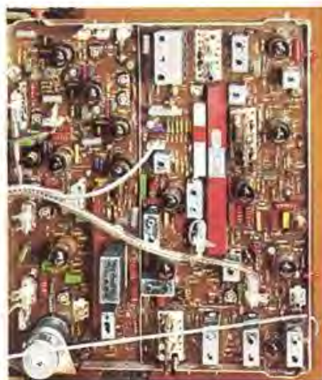
Diese Chassisplatte zeigt einen Teil des Innenlebens eines SABA Farbempfängers. Die reichhaltige Bestückung mit Transistoren, Dioden, Röhren, Widerständen, Kondensatoren, Spulen und anderen elektronischen Bauteilen lassen ahnen, welche aufwendige Technik notwendig ist, um ein farbiges Fernsehbild entstehen zu lassen.
