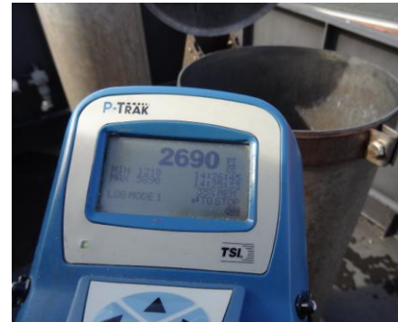
Der Partikelzähler zeigt eine sehr geringe Konzentration ultrafeiner Partikel direkt am Schornstein Foto:NABU/Diesener
