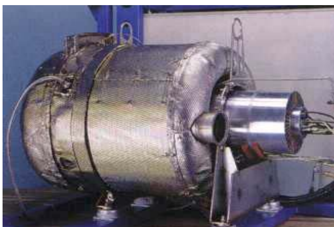
Abbildung 17: Mikroturbine des Typs FP-CS-30 mit einer Wärmeleistung von etwa 69 kW (Quelle: FP Turbomachinery)
