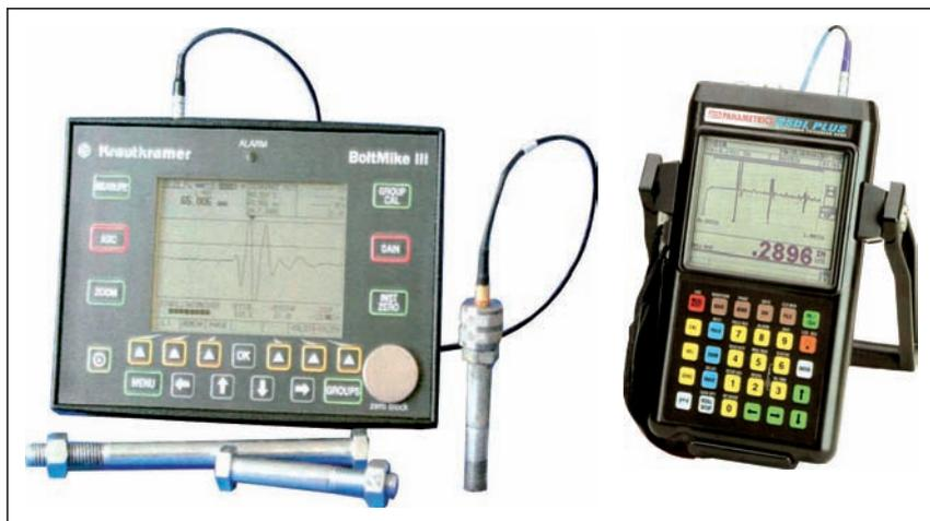
Abb. 1: BoltMike III /6/ und 25 DL PLUS /7/ sind häufig eingesetzte Geräte zur offline Bestimmung der Schraubenvorspannkraft
