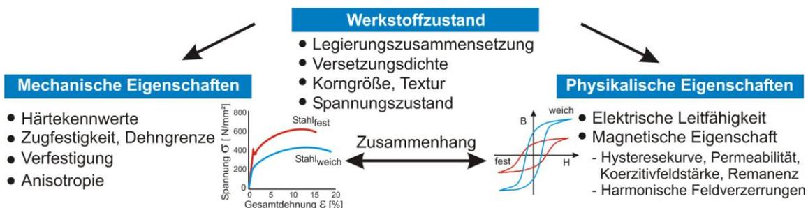
Bild 1: Indirekte Bestimmung mechanischer Bauteileigenschaften
