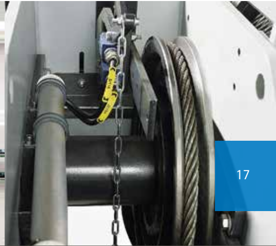
Frei zugängliche Umlenkrollen und hakenbetätigter Hubnotenschalter
