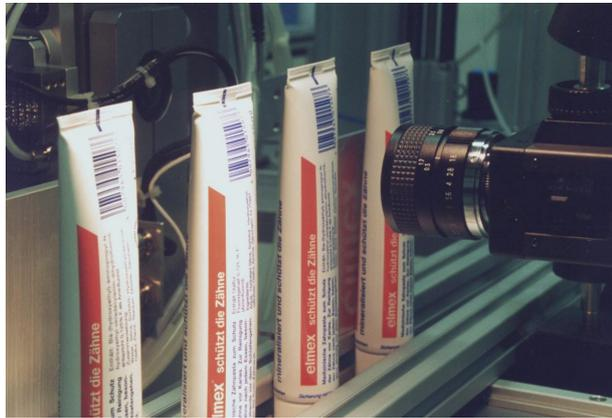
Prüfung von Barcodes auf Zahnpastatuben mit NeuroCheck
