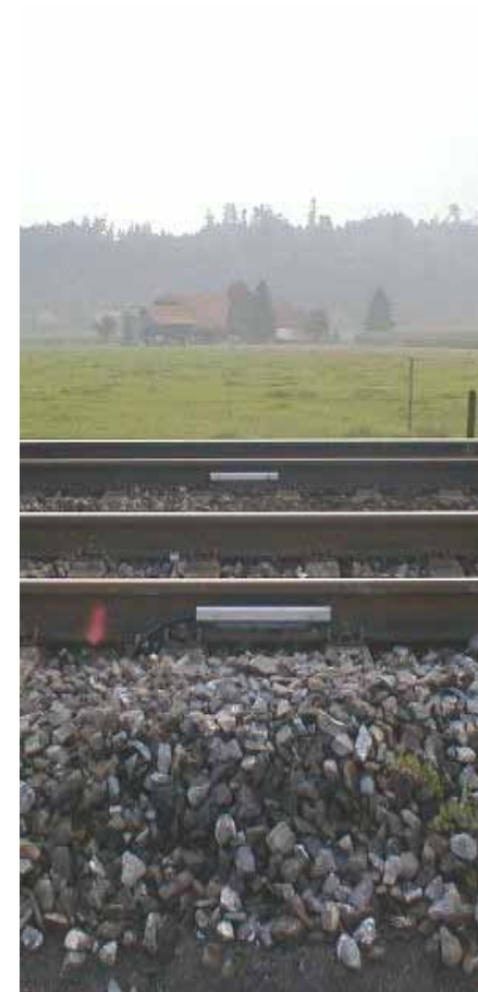
Dehnmessstreifen als Achszähler
