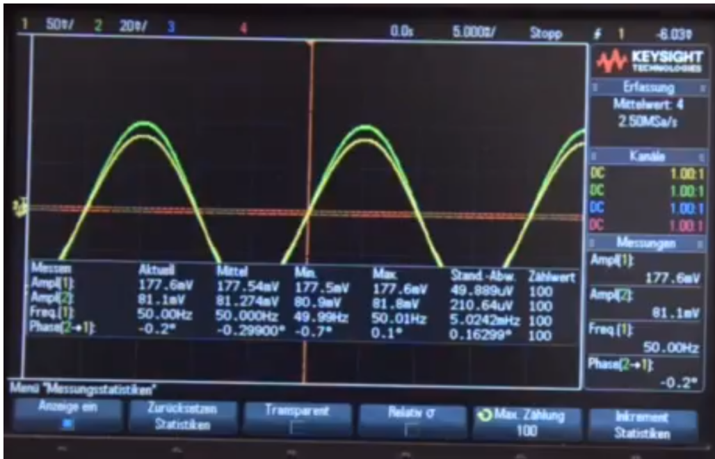
Figure 43: Galvanische Einkopplung, gelb: U_I mit 50mV/div und 0.0s/div, grün: U_{II} mit 20mV/div und 5ms/div, DC-Kopplung, Tastkopf 1:1, DSO-Impedanz: 50Ω
