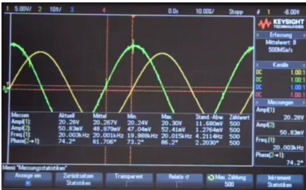
Figure 38: Kapazitive Einkopplung, gelb: U_I mit 5V/div und 0.0s/div, grün: U_{II} mit 10mV/div und 10 \mu s/div, DC-Kopplung, Tastkopf 1:1, DSO-Impedanz: 1 M \Omega
