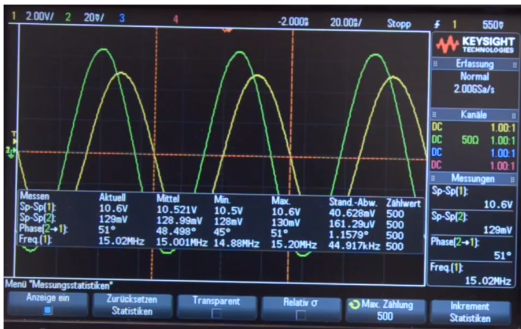
Figure 46: Kapazitive Einkopplung auf PCB-Print, gelb: U_{I,pp} mit 2V/div und -2ns/div, grün: U_{II,pp} mit 20mV/div und 20ns/div, DC-Kopplung, Tastkopf 1:1, DSO-Impedanz: 1 M \Omega
