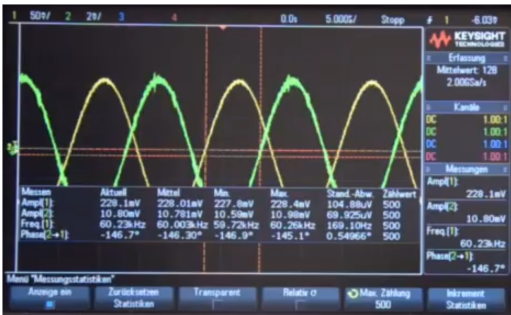
Figure 20: Induktive Einkopplung, gelb: U_I mit 50mV/div und 0.0s/div, grün: U_{II} mit 2mV/div und 5 \mu s/div, DC-Kopplung, Tastkopf 1:1, DSO-Impedanz: 1 M \Omega
