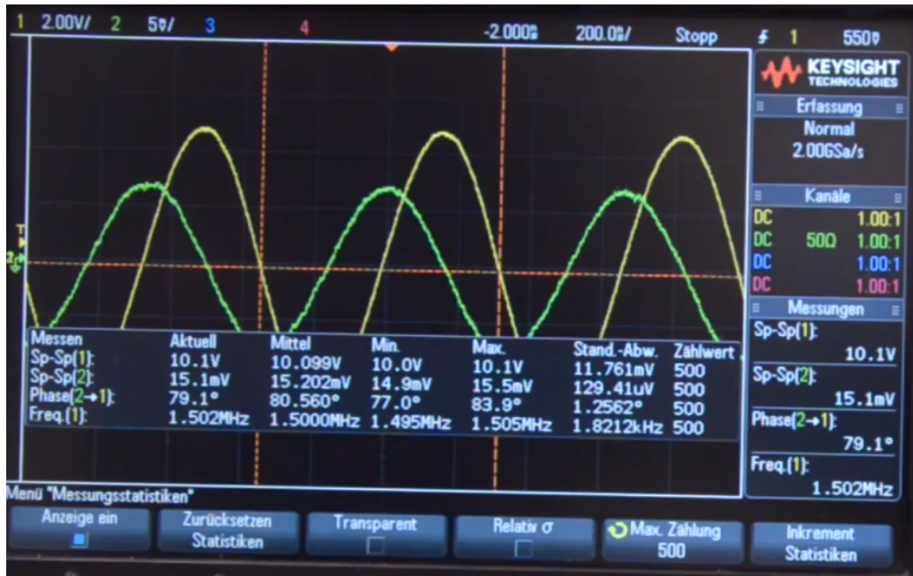
Figure 49: Kapazitive Einkopplung auf PCB-Print, gelb: U_{I,pp} mit 2V/div und -2ns/div, grün: U_{II,pp} mit 5mV/div und 200ns/div, DC-Kopplung, Tastkopf 1:1, DSO-Impedanz: 1 M \Omega
