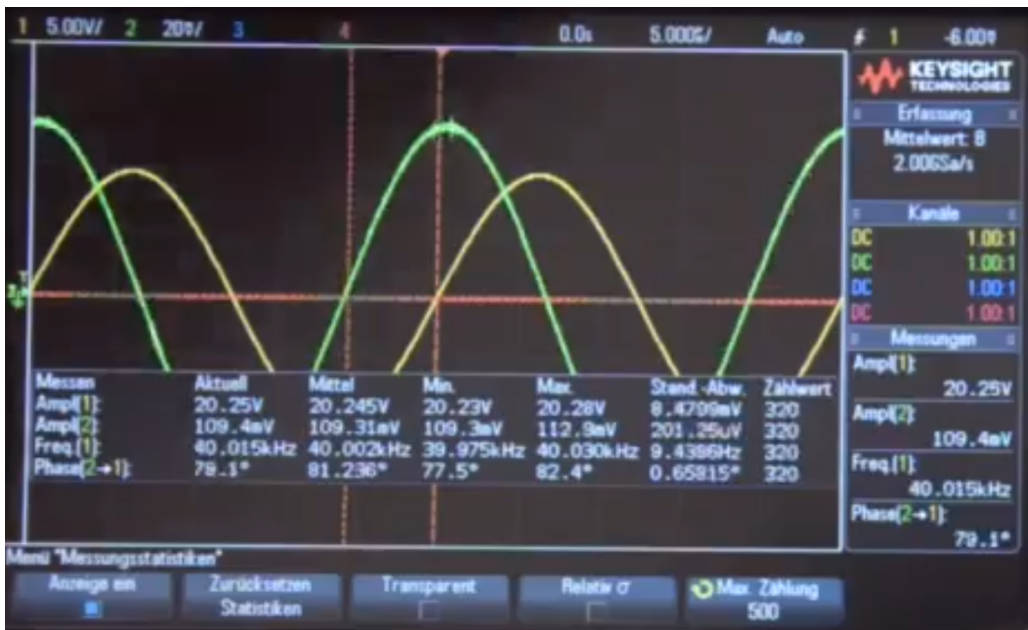
Figure 26: Kapazitive Einkopplung, gelb: U_I mit 5V/div und 0.0s/div, grün: U_{II} mit 20mV/div und 5 \mu s/div, DC-Kopplung, Tastkopf 1:1, DSO-Impedanz: 1 M \Omega
