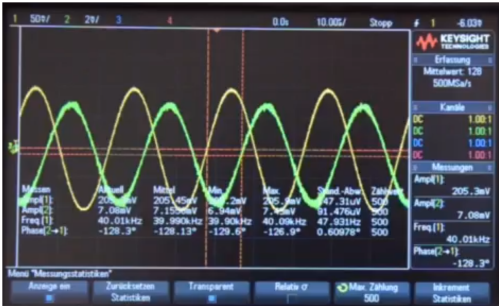
Figure 19: Induktive Einkopplung, gelb: U_I mit 50mV/div und 0.0s/div, grün: U_{II} mit 2mV/div und 10 \mu s/div, DC-Kopplung, Tastkopf 1:1, DSO-Impedanz: 1 M \Omega
