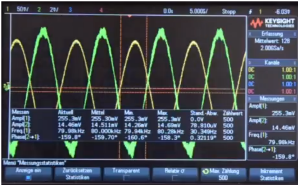
Figure 21: Induktive Einkopplung, gelb: U_I mit 50mV/div und 0.0s/div, grün: U_{II} mit 2mV/div und 5µs/div, DC-Kopplung, Tastkopf 1:1, DSO-Impedanz: 1 MΩ
