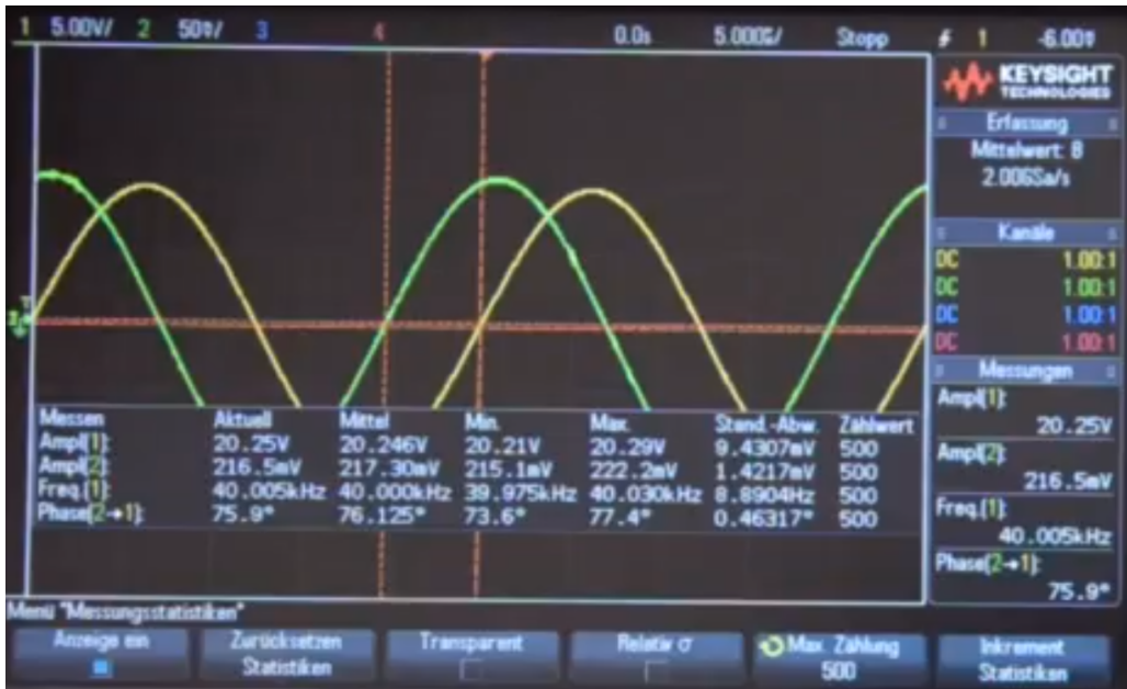
Figure 31: Kapazitive Einkopplung, gelb: U_I mit 5V/div und 0.0s/div, grün: U_{II} mit 50mV/div und 5 \mu s/div, DC-Kopplung, Tastkopf 1:1, DSO-Impedanz: 1 M \Omega
