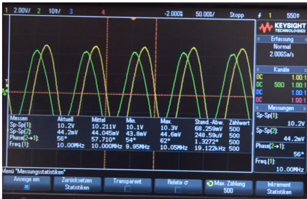
Figure 50: Kapazitive Einkopplung auf PCB-Print, gelb: U_{I,pp} mit 2V/div und -2ns/div, grün: U_{II,pp} mit 10mV/div und 50ns/div, DC-Kopplung, Tastkopf 1:1, DSO-Impedanz: 1 M \Omega
