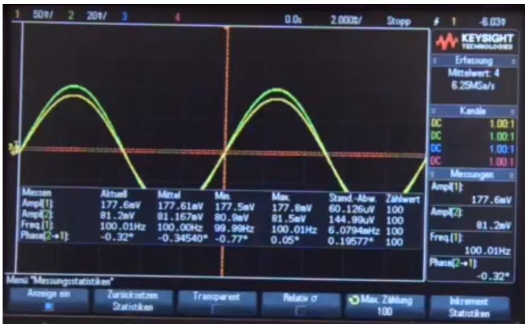
Figure 44: Galvanische Einkopplung, gelb: U_I mit 50mV/div und 0.0s/div, grün: U_{II} mit 20mV/div und 2ms/div, DC-Kopplung, Tastkopf 1:1, DSO-Impedanz: 50Ω
