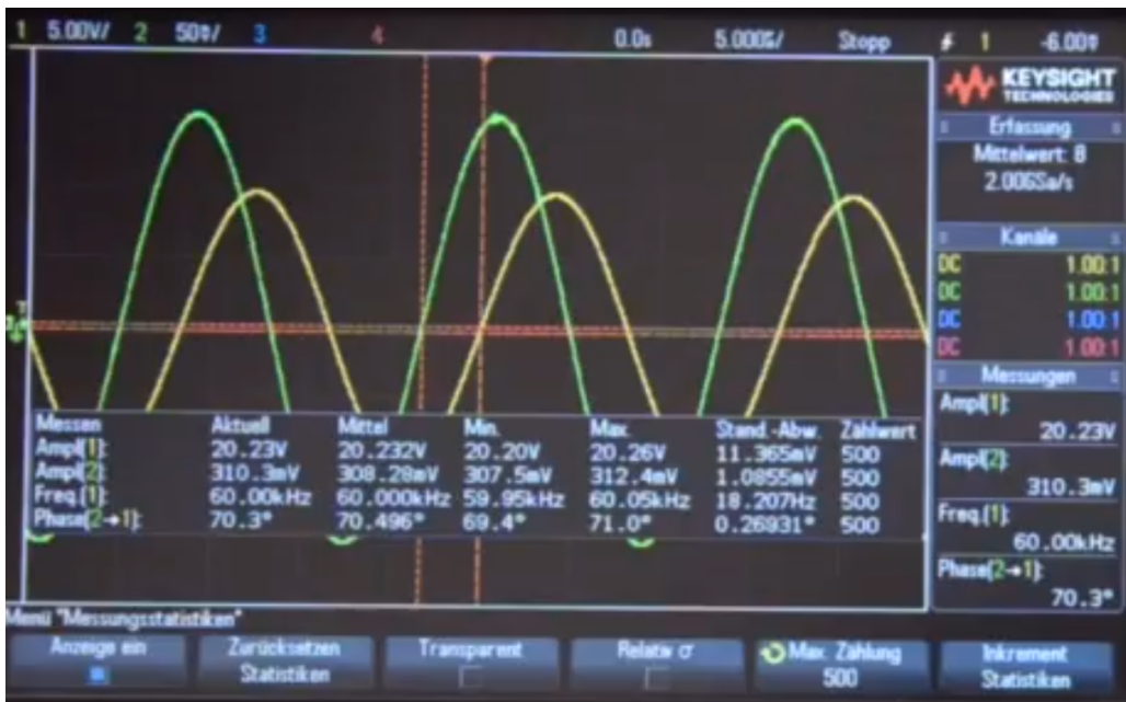
Figure 32: Kapazitive Einkopplung, gelb: U_I mit 5V/div und 0.0s/div, grün: U_{II} mit 50mV/div und 5 \mu s/div, DC-Kopplung, Tastkopf 1:1, DSO-Impedanz: 1 M \Omega
