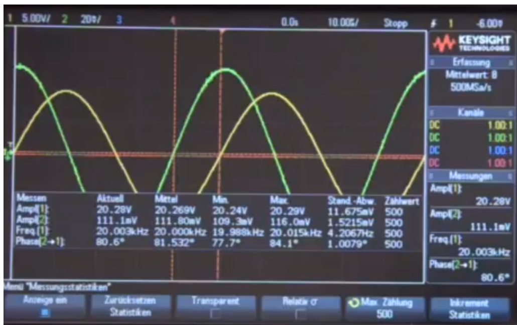
Figure 30: Kapazitive Einkopplung, gelb: U_I mit 5V/div und 0.0s/div, grün: U_{II} mit 20mV/div und 10 \mu s/div, DC-Kopplung, Tastkopf 1:1, DSO-Impedanz: 1 M \Omega
