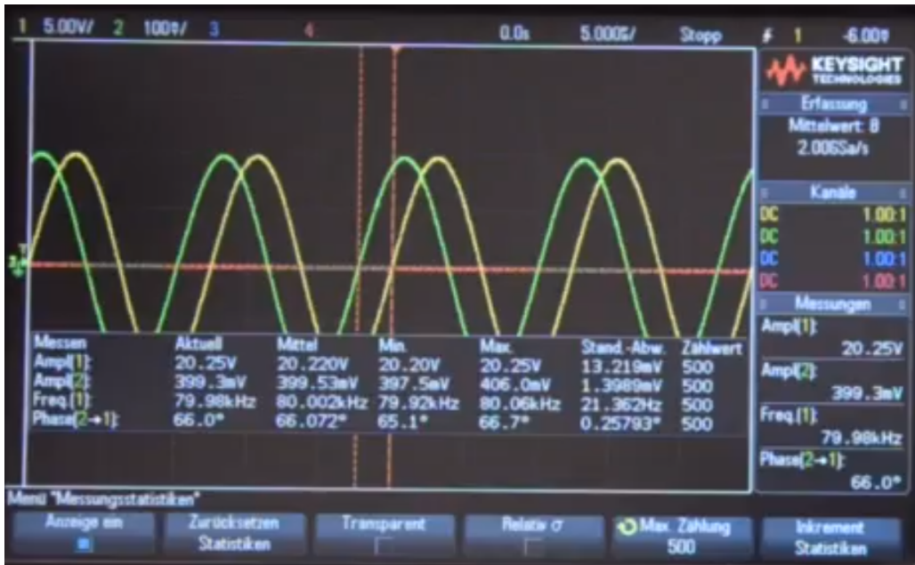
Figure 33: Kapazitive Einkopplung, gelb: U_I mit 5V/div und 0.0s/div, grün: U_{II} mit 100mV/div und 5µs/div, DC-Kopplung, Tastkopf 1:1, DSO-Impedanz: 1 MΩ
