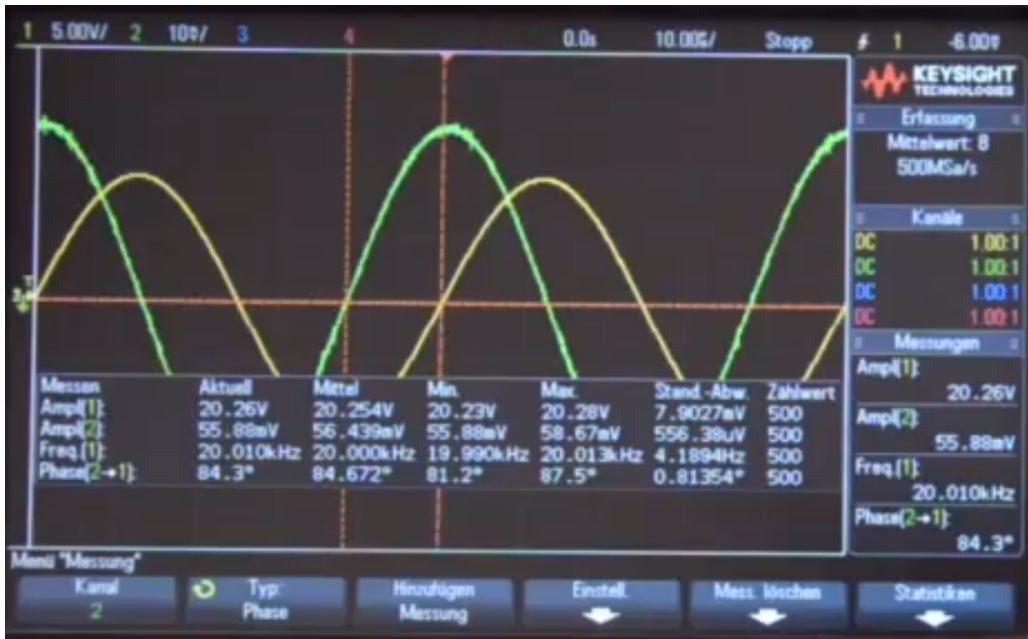
Figure 25: Kapazitive Einkopplung, gelb: U_I mit 5V/div und 0.0s/div, grün: U_{II} mit 10mV/div und 10 \mu s/div, DC-Kopplung, Tastkopf 1:1, DSO-Impedanz: 1 M \Omega
