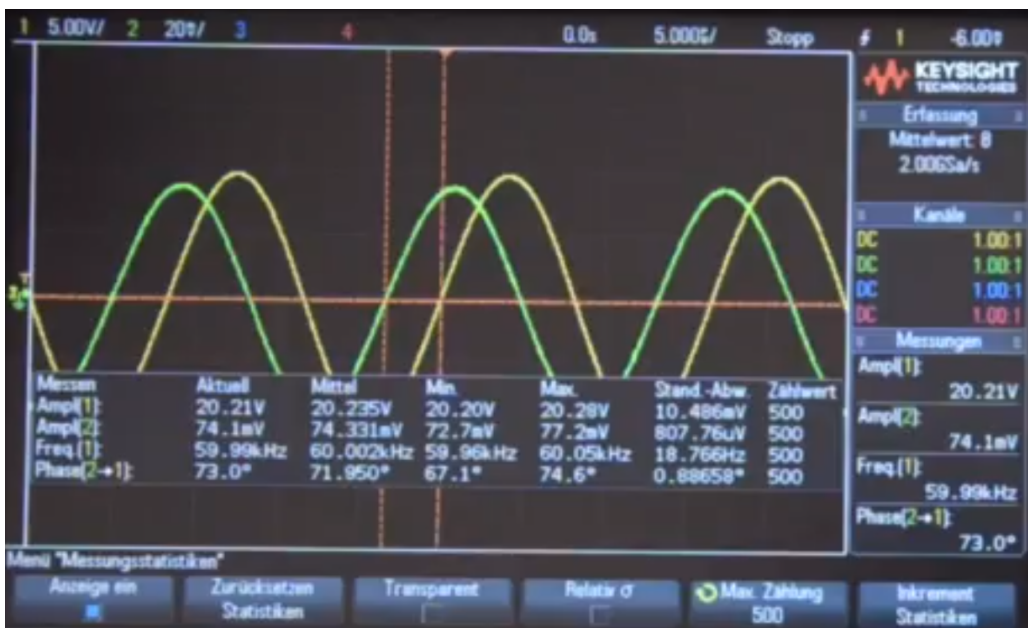
Figure 36: Kapazitive Einkopplung, gelb: U_I mit 5V/div und 0.0s/div, grün: U_{II} mit 20mV/div und 5 \mu s/div, DC-Kopplung, Tastkopf 1:1, DSO-Impedanz: 1 M \Omega
