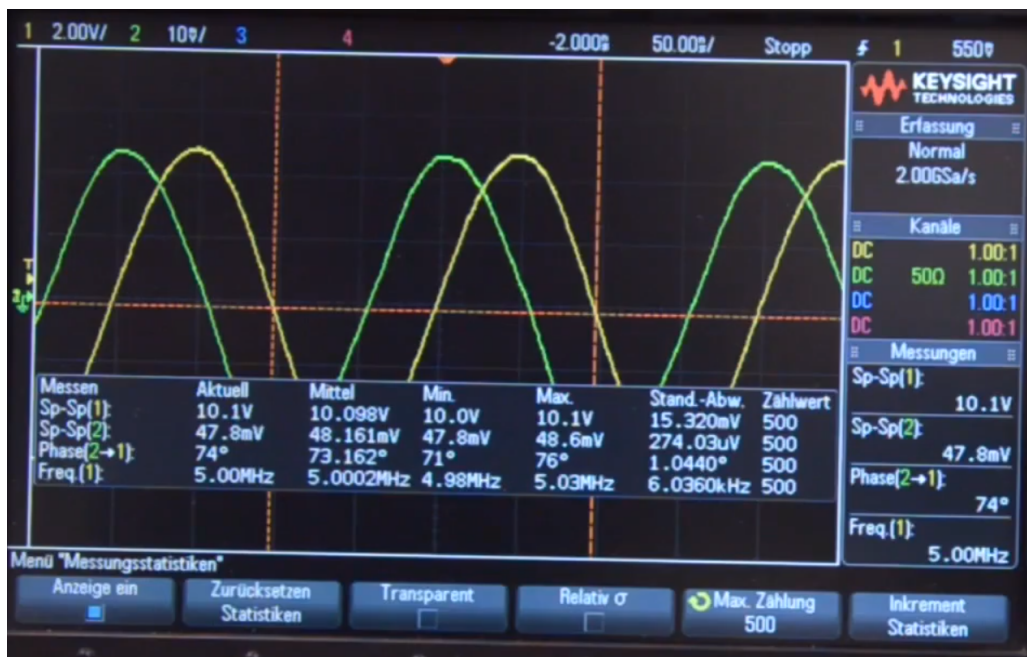
Figure 48: Kapazitive Einkopplung auf PCB-Print, gelb: U_{I,pp} mit 2V/div und -2ns/div, grün: U_{II,pp} mit 10mV/div und 50ns/div, DC-Kopplung, Tastkopf 1:1, DSO-Impedanz: 1 M \Omega
