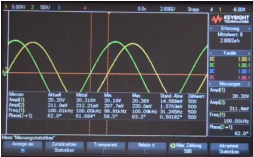
Figure 39: Kapazitive Einkopplung, gelb: U_I mit 5V/div und 0.0s/div, grün: U_{II} mit 50mV/div und 2 \mu s/div, DC-Kopplung, Tastkopf 1:1, DSO-Impedanz: 1 M \Omega
