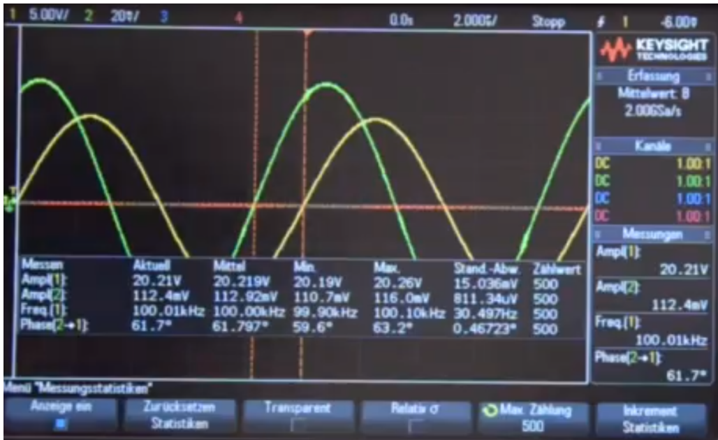
Figure 35: Kapazitive Einkopplung, gelb: U_I mit 5V/div und 0.0s/div, grün: U_{II} mit 20mV/div und 2 \mu s/div, DC-Kopplung, Tastkopf 1:1, DSO-Impedanz: 1 M \Omega
