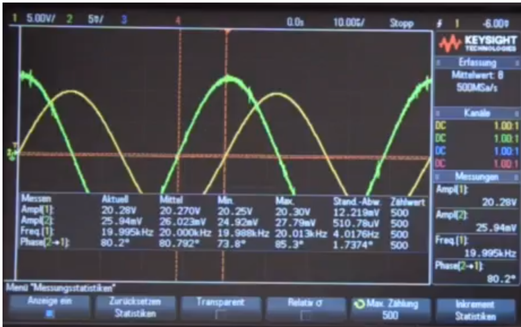
Figure 37: Kapazitive Einkopplung, gelb: U_I mit 5V/div und 0.0s/div, grün: U_{II} mit 5mV/div und 10 \mu s/div, DC-Kopplung, Tastkopf 1:1, DSO-Impedanz: 1 M \Omega
