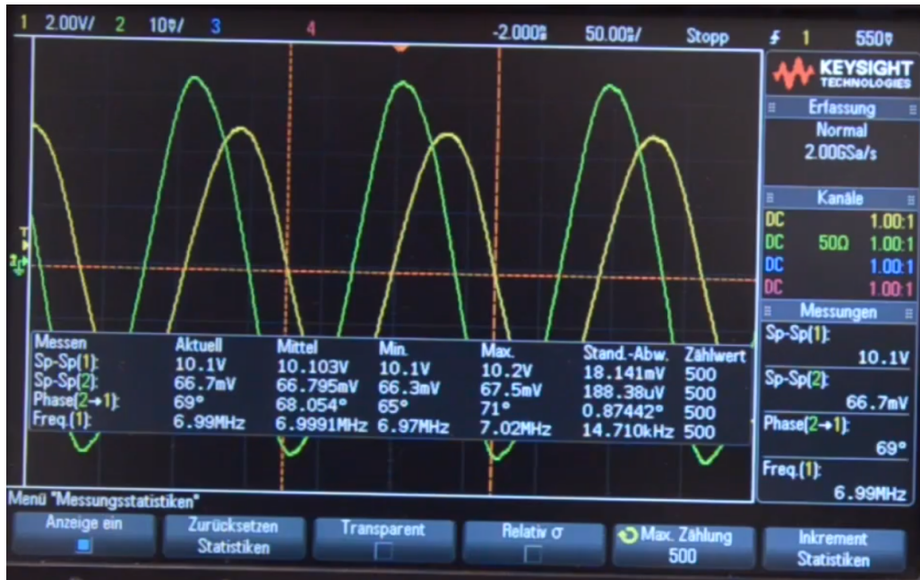
Figure 47: Kapazitive Einkopplung auf PCB-Print, gelb: U_{I,pp} mit 2V/div und -2ns/div, grün: U_{II,pp} mit 10mV/div und 50ns/div, DC-Kopplung, Tastkopf 1:1, DSO-Impedanz: 1 M \Omega
