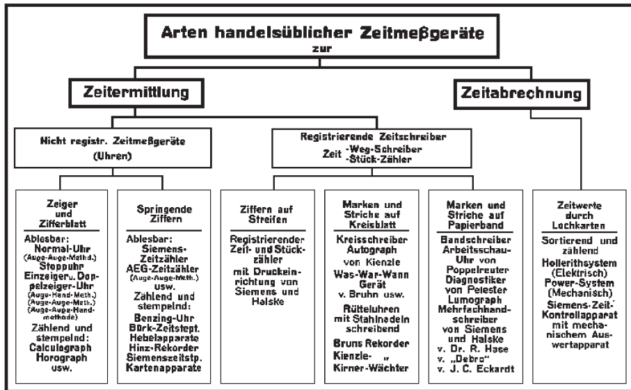
Abb. 8: Handelsübliche Zeitmessinstrumente geordnet nach Konstruktionsmerkmalen, 1929. Quelle: Ausschuß für Handarbeit (AWF) (Hg.), Grundlagen für Arbeitsvorbereitung, Zeitstudien, Berlin 1929, S. 29.
