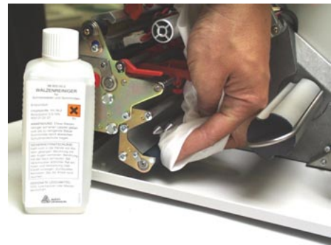
[6] Links: Ausziehmodul herausziehen. Rechts: Spender-Vorschubwalze mit Walzenreiniger abwischen.
