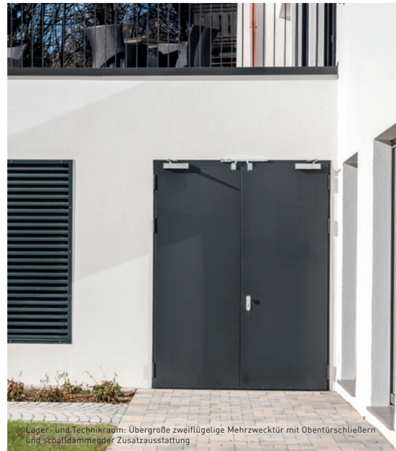
Rohrrahmentüren NovoFire® Thermo EI, 30 C5 für die Außenanwendung mit stabilen Aluminiumprofilen (4 mm Wandstärke), thermisch getrenntem Profil-System und einem Wärmedurchgangskoeffizienten von U_D = 1,7 - 2,2 \text{ W/m}^2\text{K}
