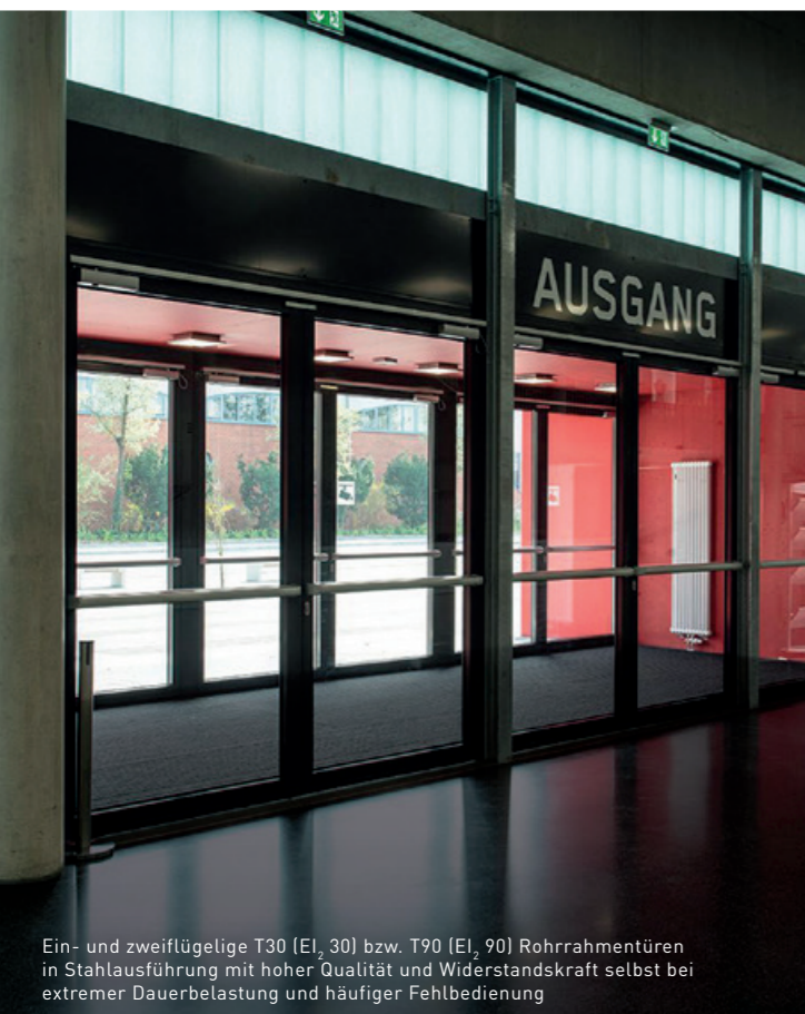
Zweiflügelige Feuerschutztüren T30-2 (EI 2 30), T60 (EI 2 60) oder T90-2 (EI 2 90) mit Vollpanikfunktionen nach DIN EN 1125 mit getriebegelagerten Touch- oder Pushbars
