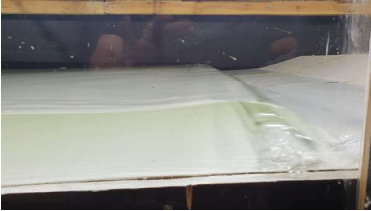
Abbildung 39: Seitenansicht auflaufende Welle – zusammenbrechender Tunnel
