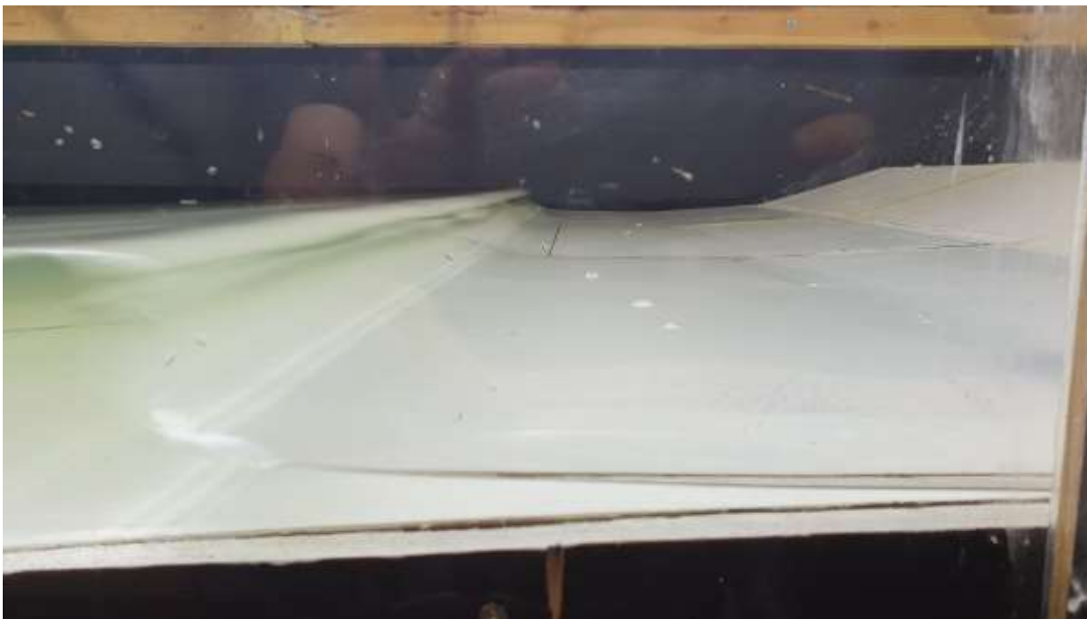
Abbildung 38: Seitenansicht auflaufende Welle – überschlagende Wellenfront mit Ausbildung Tunnel
