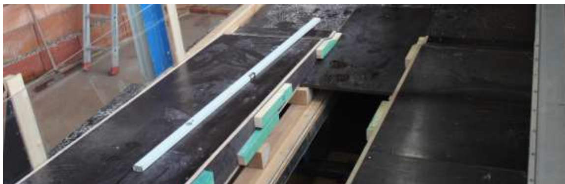
Abbildung 27: AgF - Wellenkanal mit eingesetztem linken und rechten Profilteil
