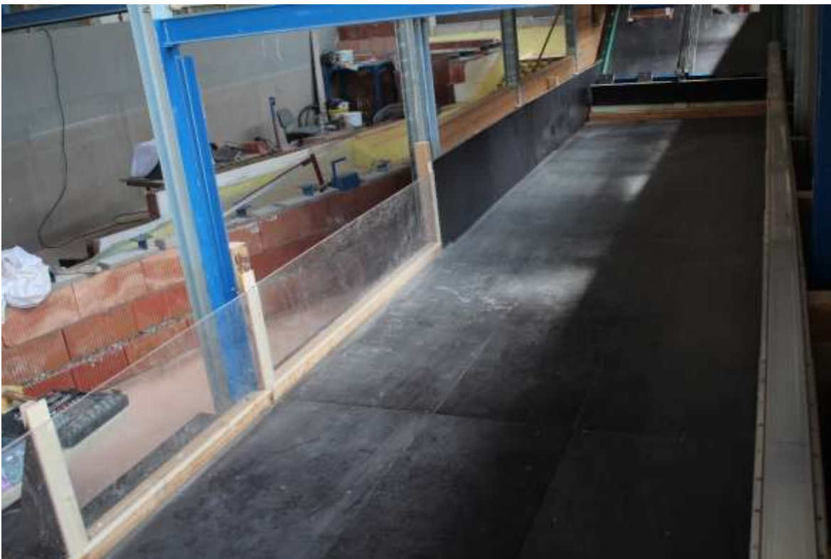
Abbildung 26: AgF - Wellenkanal mit Wellengenerator (Einmalwelle) und seitlicher Beobachtungsraum
