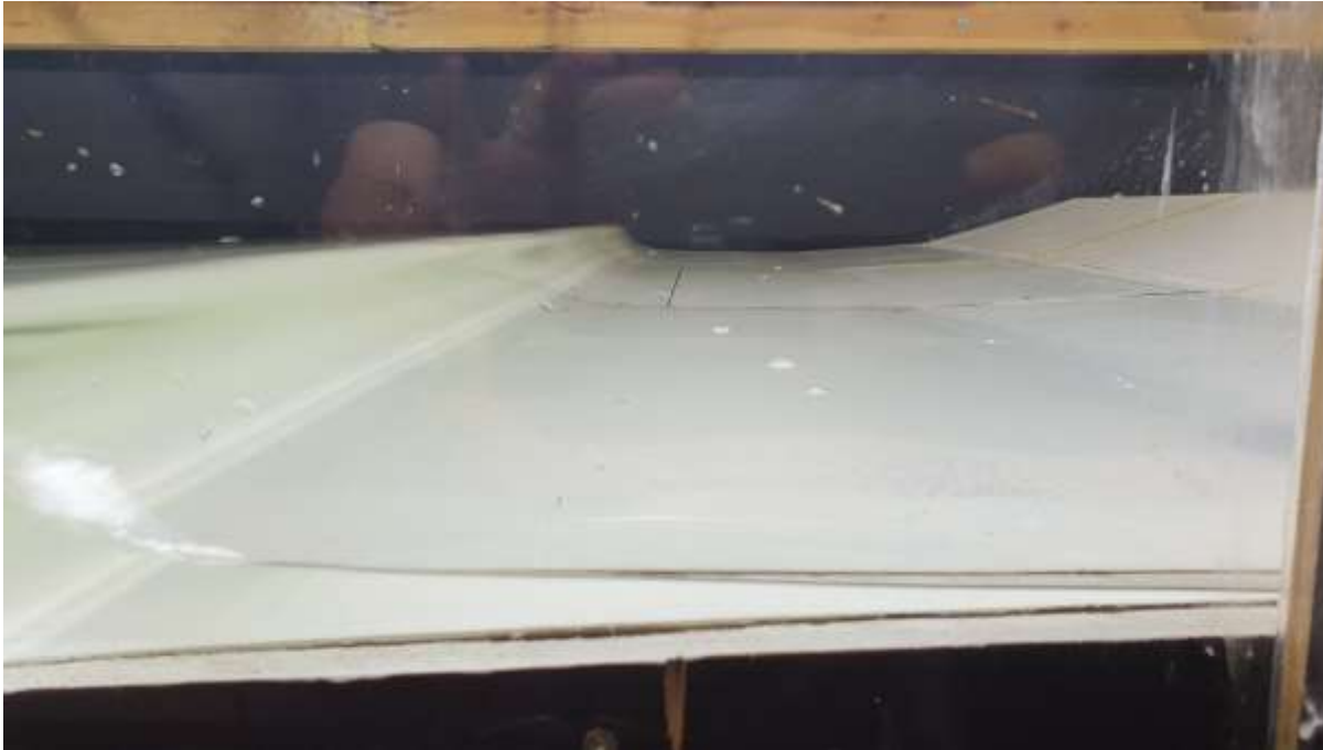
Abbildung 37: Seitenansicht auflaufende Welle – steile Wellenfront
