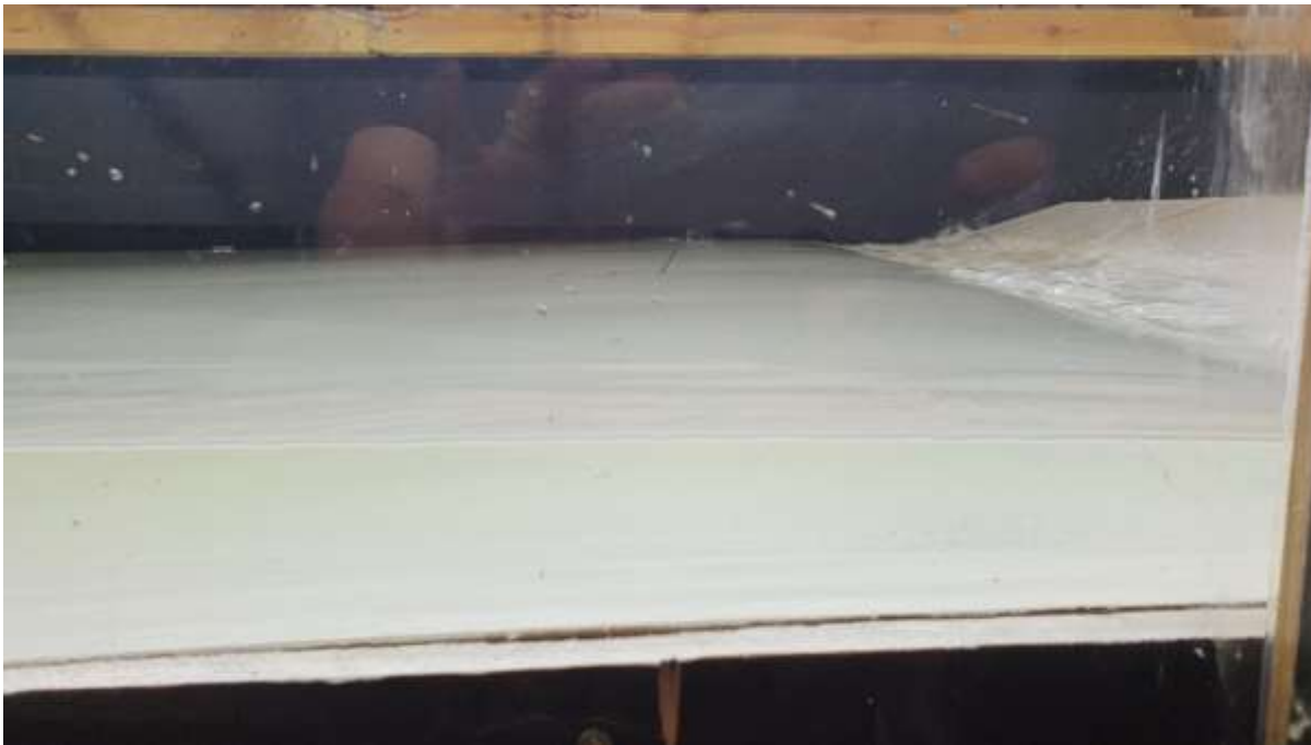
Abbildung 40: Seitenansicht auflaufende Welle – herausschießender Wasserkeil aus zusammengebrochenem Wellentunnel
