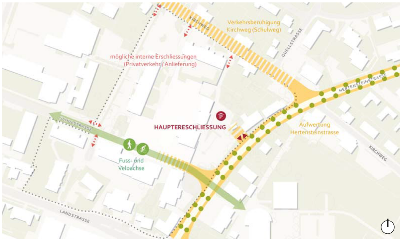
Abb. 6 Zielbild Erschliessung (Erschliessungskonzept Metron Verkehrsplanung AG, 8. Oktober 2018)
