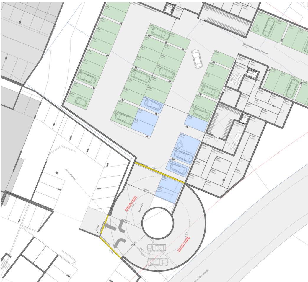
Abb. 14 Öffentliche Parkplätze (blau einge- färbt), Erschlies- sung Herten- steinstrasse mit Spindel- rampe
