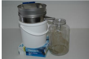
Abbildung 8: Siebsystem zur Isolierung der Fraktion <63 µm (Foto: Kanton Bern).
