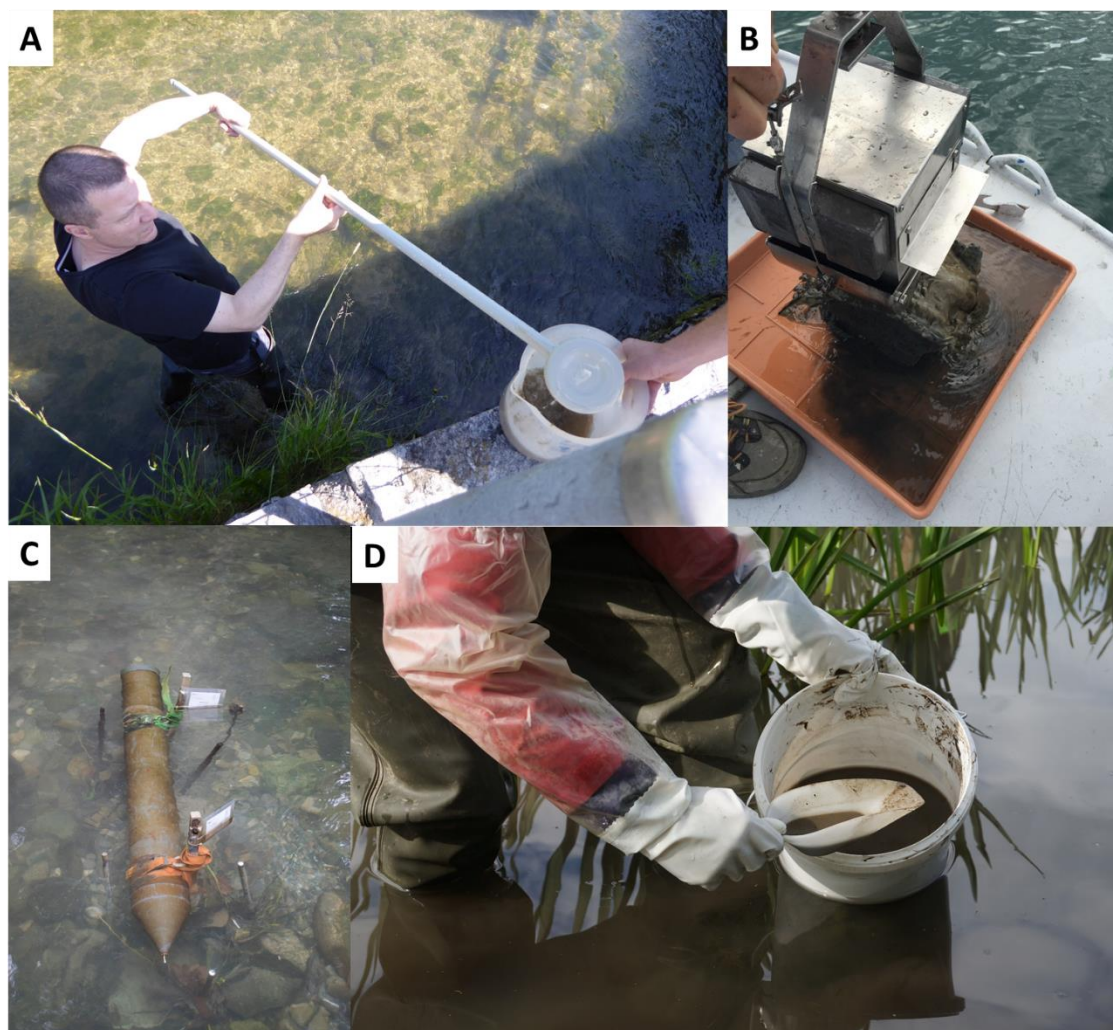
Abbildung 5: Verschiedene Probenahmegeräte, die im Feld verwendet werden können. A) Teleskop-Probenehmer B) Ekman-Greifer C) Zeitintegrierter Schwebstoff-Röhrensammler D) Schaufel.
