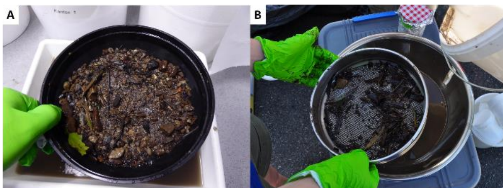
Abbildung 7: Beispiel einer 2 mm - Nasssiebung. (A) Off-site mit inerter Ausrüstung für die Spurenmetallanalyse und (B) In-situ mit inerter Ausrüstung für die Analyse organischer Mikroverunreinigungen.
