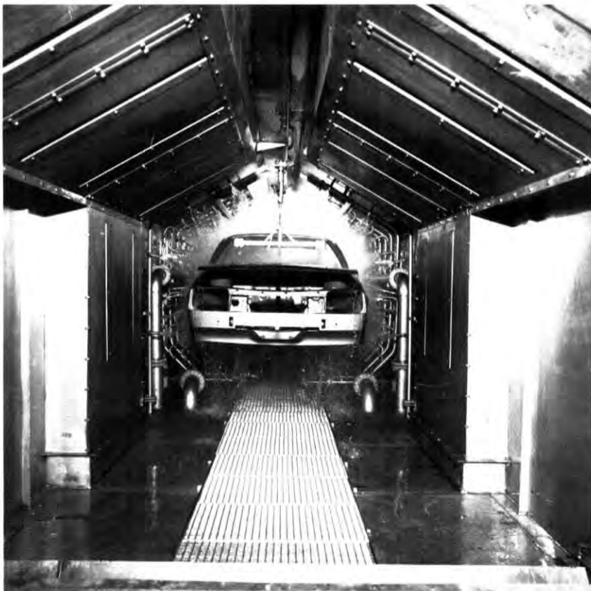
Auslauf aus der achten und letzten Zone der Zink-Spritz-Phosphatieranlage.
