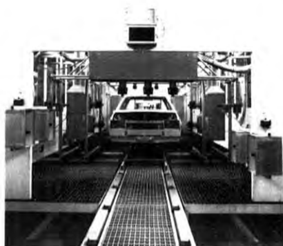
Eine elektrostatische Rotations-Zerstäubungsanlage für die Decklackierung. Der Farbtonwechsel erfolgt vollautomatisch und enthält die gesamte Farbtonpalette.
