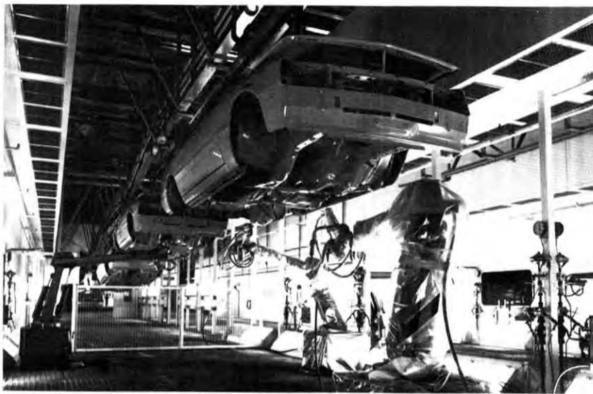
Abdicht- und Steinschlagschutzmaßnahmen am Karosserie-Unterbau. Roboter haben die unangenehme „Überkopfarbeit“ übernommen und tragen das PVC-Material vollautomatisch auf.
