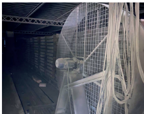
Trockner mit Heißluft-Zufuhr und Ventilation
