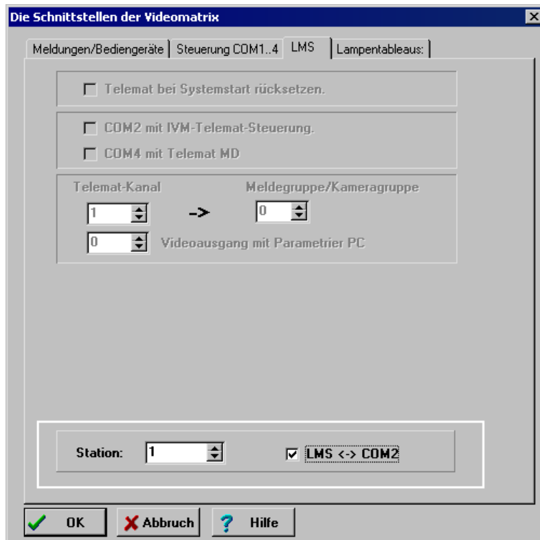
Abb. 79 Anschluss von LMS an SIMATRIX 164 – TELEMAT/SISTORE-NT/LMS
