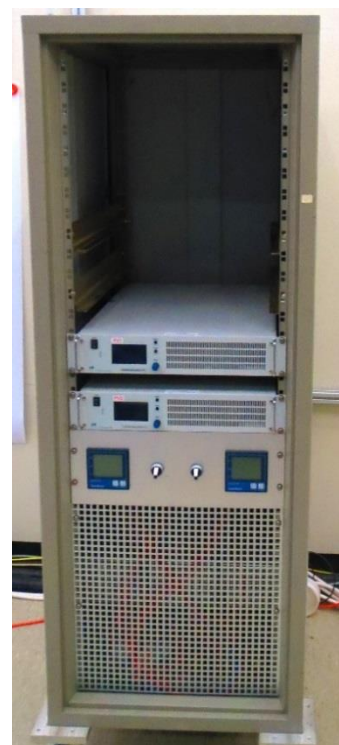
Abbildung 3.29: DC-Quellen (oben) und Leitungsnachbildung (unten)
