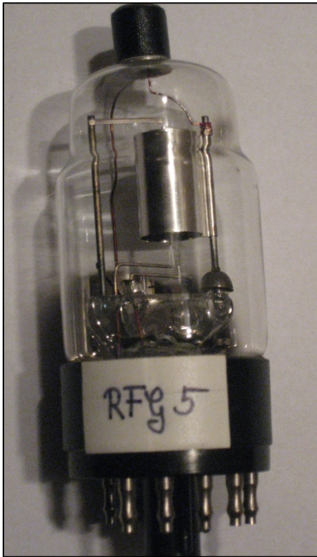
Abb. 5.15: (Hochspannungs-)Einweggleichrichter RFG5 (Telefunken).
