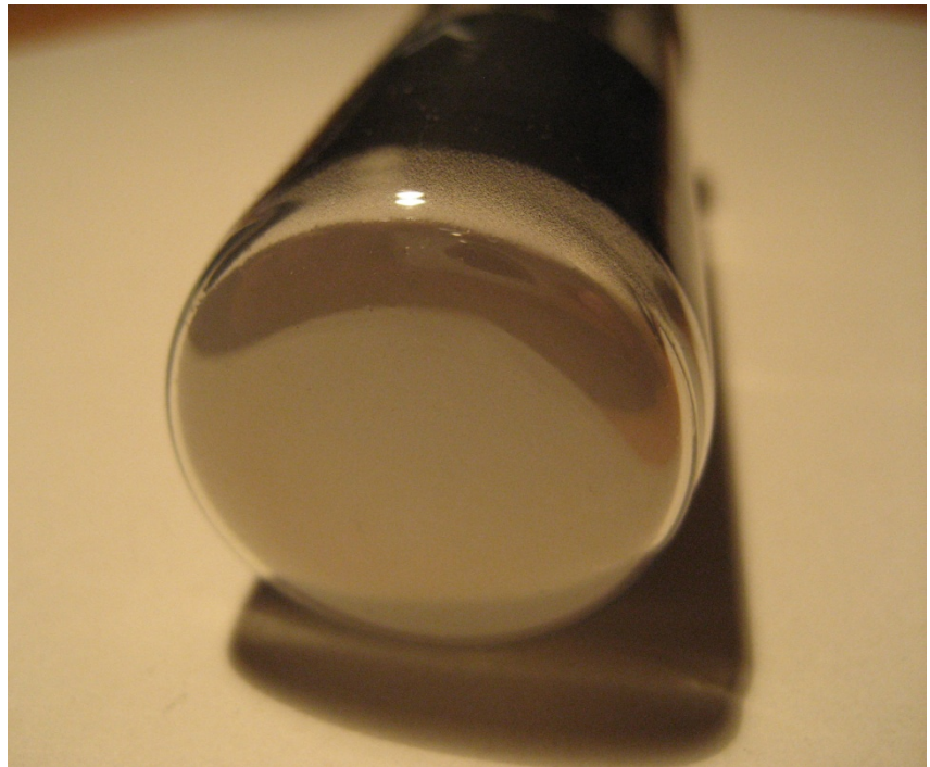
Abb. A.1: Miniatur-Oszillographenröhre DH-3-91 mit Zinksulfit/Zinksilikat-Leuchtschicht (Valvo). Die Röhre erzeugt dasselbe Leuchtbild wie eine Standardkathodenstrahlröhre. Durch Anlegen von amplitudenmodulierten Kippspannungen an den Ablenkkondensatoren wird aus der Oszillographenröhre eine Aussteuerungsanzeige.
