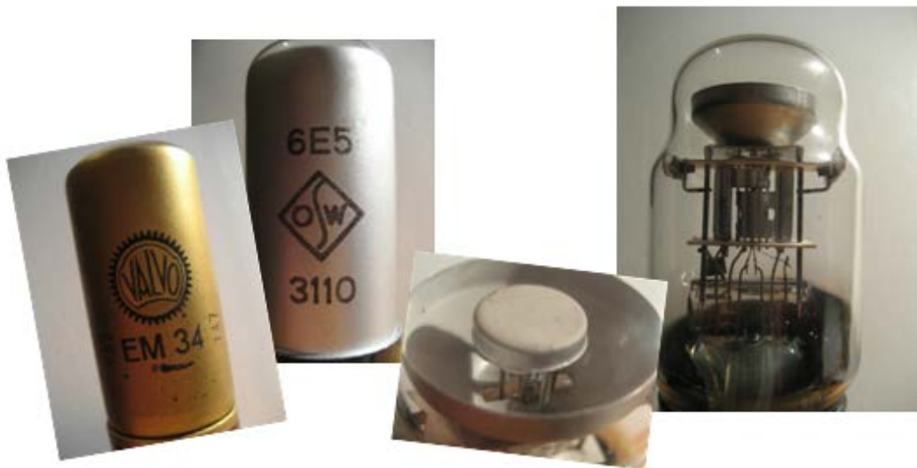
Abb. 2.1: Verschiedene Abstimmanzeigeröhren mit kegelförmiger Leuchtanode („Magische Augen“)
