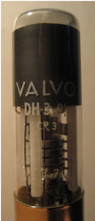
Abb. A.1: Miniatur-Oszillographenröhre DH-3-91 mit Zinksulfit/Zinksilikat-Leuchtschicht (Valvo). Die Röhre erzeugt dasselbe Leuchtbild wie eine Standardkathodenstrahlröhre. Durch Anlegen von amplitudenmodulierten Kippspannungen an den Ablenkkondensatoren wird aus der Oszillographenröhre eine Aussteuerungsanzeige.
