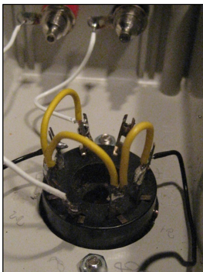
Abb. 5.3: Verdrahtung des Low-Cost-Röhrenmoduls.
