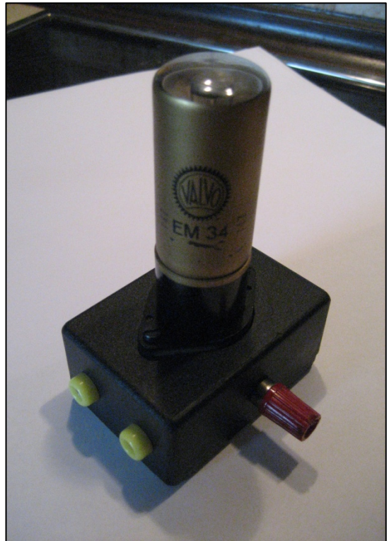
Abb. 5.9: Röhrenadapter für den „Normalbetrieb des Magischen Auges. Rechts im Vordergrund liegt der separat herausgeführte Gitteranschluss (rote Buchse).
