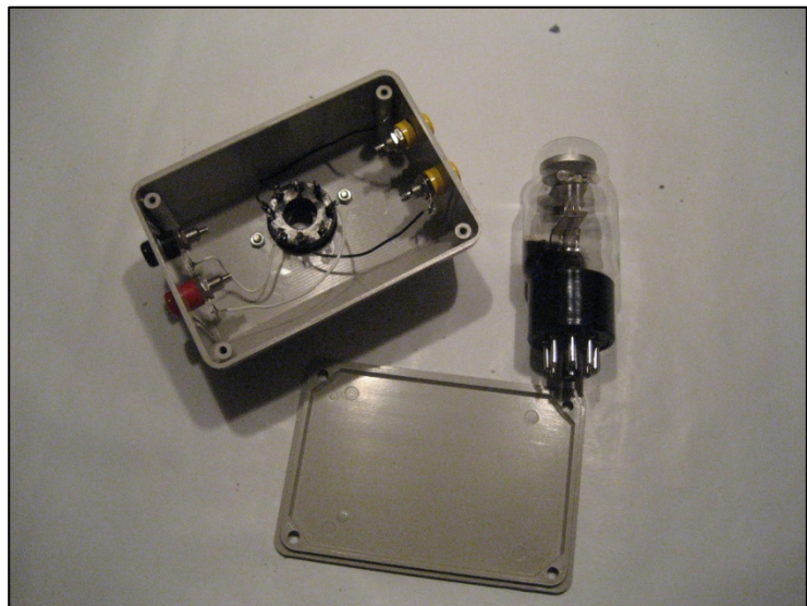
Abb. 5.2: Das Innere des Low-Cost-Röhrenmoduls.
