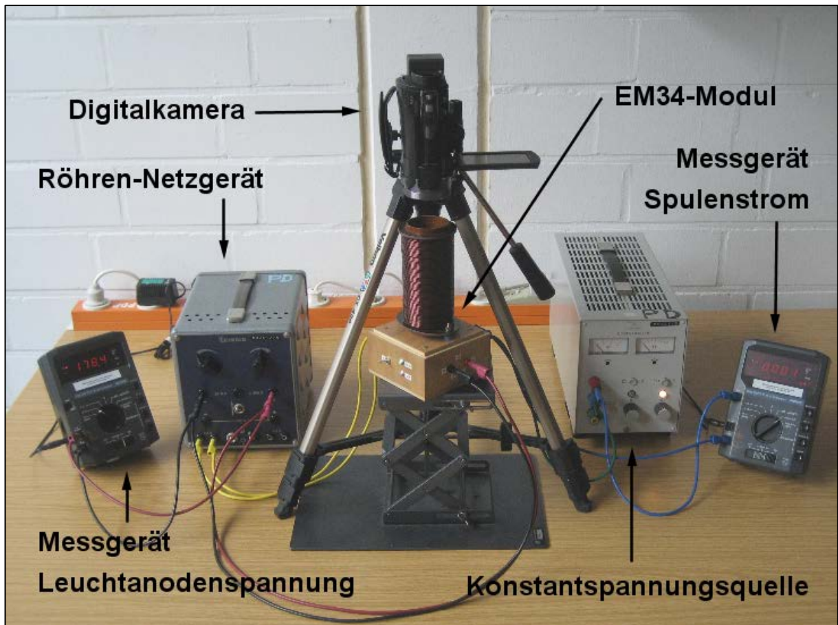
Abb. 3.1: Fertiger Versuchsaufbau zur e/m -Messung mit dem Magischen Auge EM34. Die Spulenkonstante wird in einem Vorversuch mit einer Hallsonde ermittelt. Eine Geräteliste ist Kap. A.3 (Anhang) zu entnehmen.
