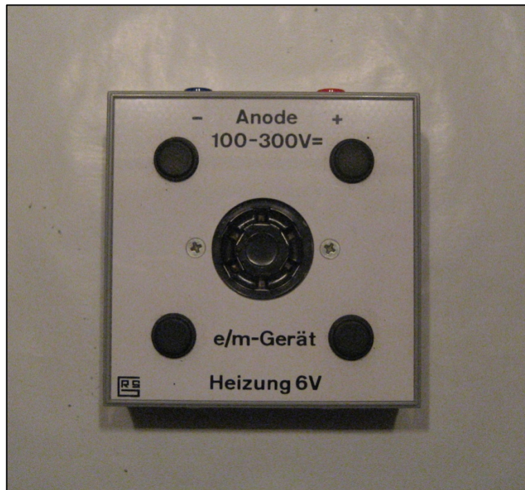
Abb. A.3a: PSSC'sches Röhrenmodul (Aufsicht). Das Gerät wurde bis zum Jahr 1999 durch die Firma „GRS-Lehrgeräte“ in der EU vertreiben.
