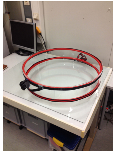
Abbildung 3.7: Verkleben der Plexiglasplatten zum Rand.
