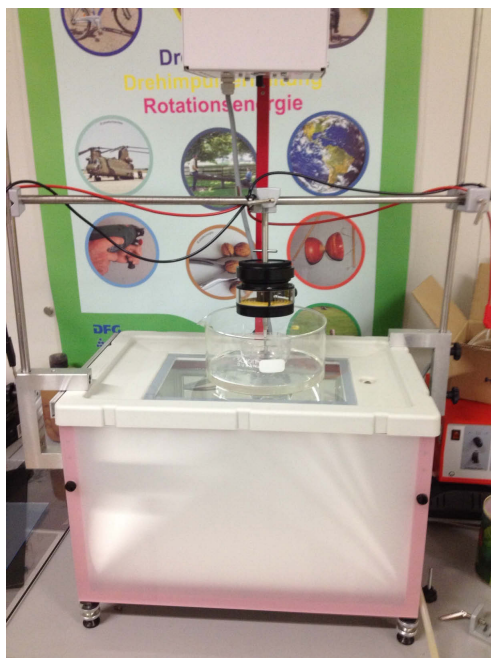
Abbildung 3.11: Prototyp 2 mit zentralem Anreger. Aufgebaut auf einer Wellenwanne der Firma LEYBOLD
