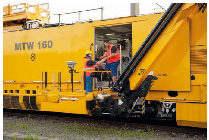
BILD 5: Beladung des Fahrzeugaumes bei abgesenkter Arbeitsbühne
