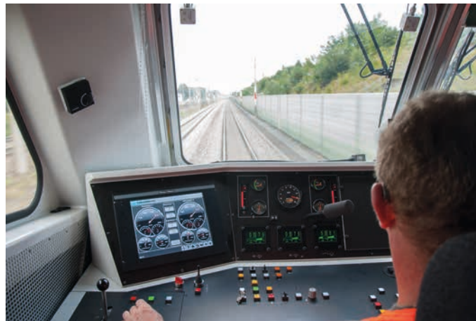
BILD 3: Fahrstand mit Touchscreen der Maschinensteuerung Plasser Intelligent Control P-IC 2.0
