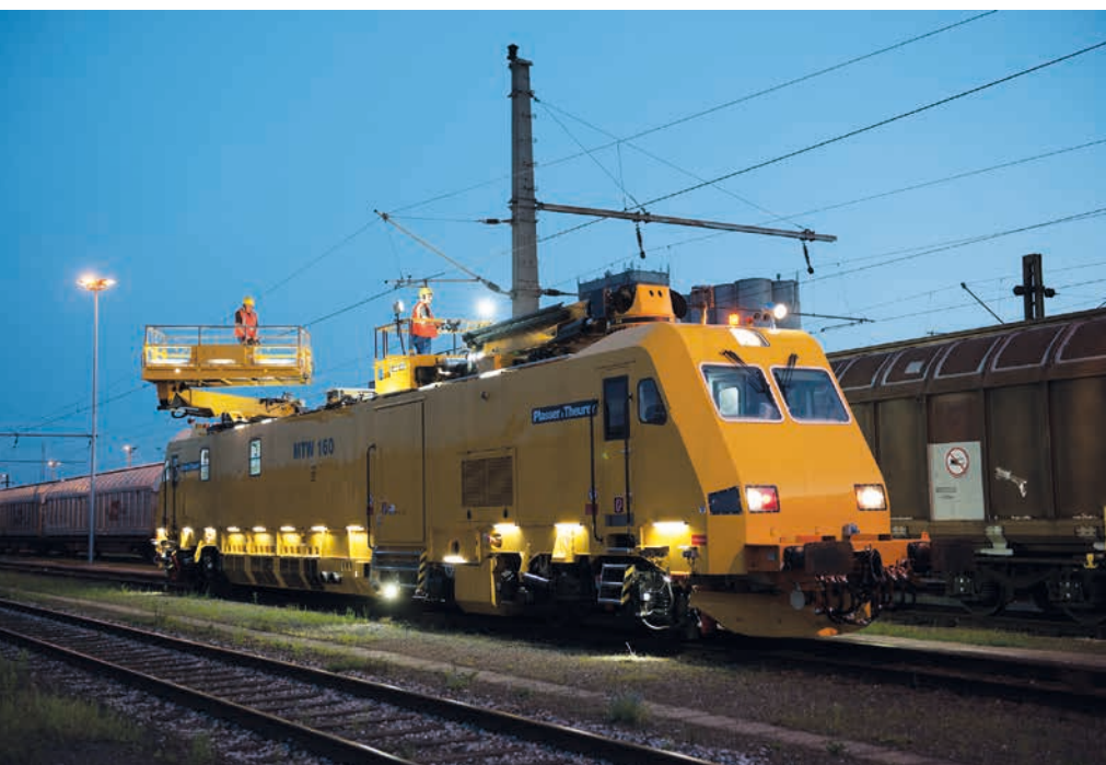
BILD 1: Schnellinterventionsfahrzeug MTW 160 für das Hochgeschwindigkeitsnetz in China (Funktionsproben in Österreich)
