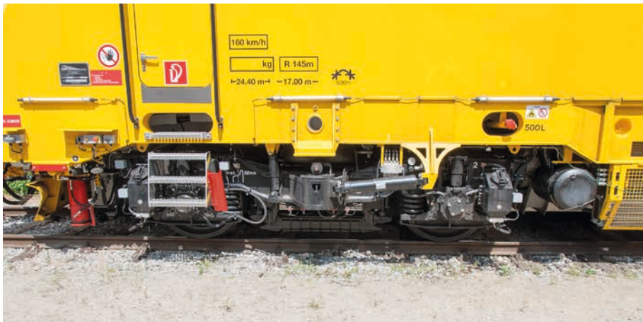
BILD 2: Innovatives Fahrwerk für 160 km/h
