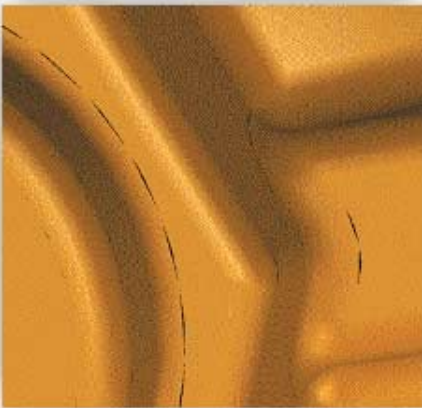
Bei reparaturbedürftigen Solid-Modellen werden Klaffungen, Lücken, Überlappungen und fehlende Verrundungen durch automatische Randerkennung tangential stetig eingefügt
