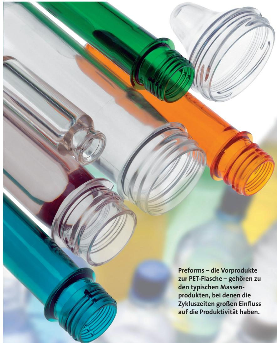
**Preforms – die Vorprodukte zur PET-Flasche – gehören zu den typischen Massenprodukten, bei denen die Zykluszeiten großen Einfluss auf die Produktivität haben.**
