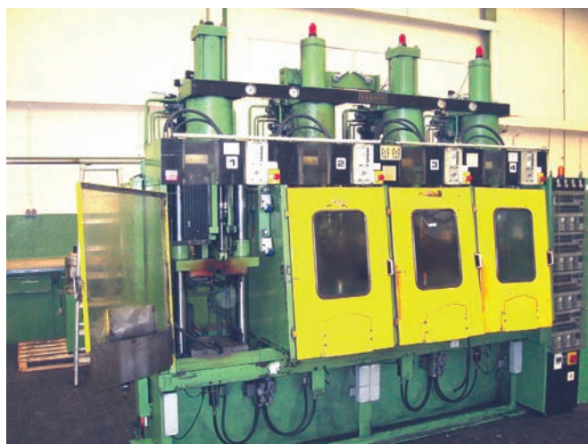
Mechanisch noch voll intakt, steuerungstechnisch aber nicht mehr auf der Höhe der Zeit, ist die alte DA40-4 produktionstechnisch ein Engpass.
