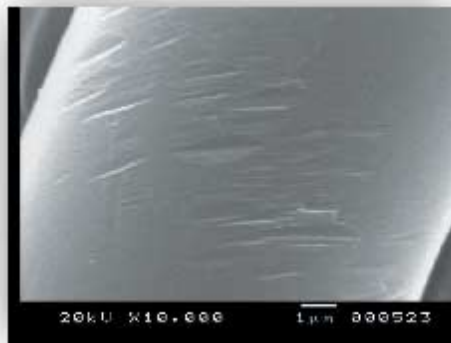
REM-Aufnahmen einer durch Chromoxid (links) und einer durch Titandioxid (rechts) geschädigten Glasfaser (1 % Farbpigment)
