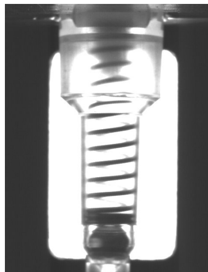
Die Anwesenheit und Montage des Zwischenkolbens, der Feder und der Kugel wird überprüft.
